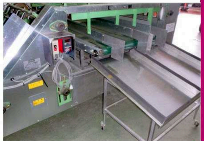
受け荷台は、本体に付属しています。 (高さ調整式、キャスター式)
